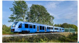
Premier exemple de développement : Le Coradia iLint en Allemagne depuis 2018 mais il fonctionne à base d'hydrogène issu de vaporeformage
